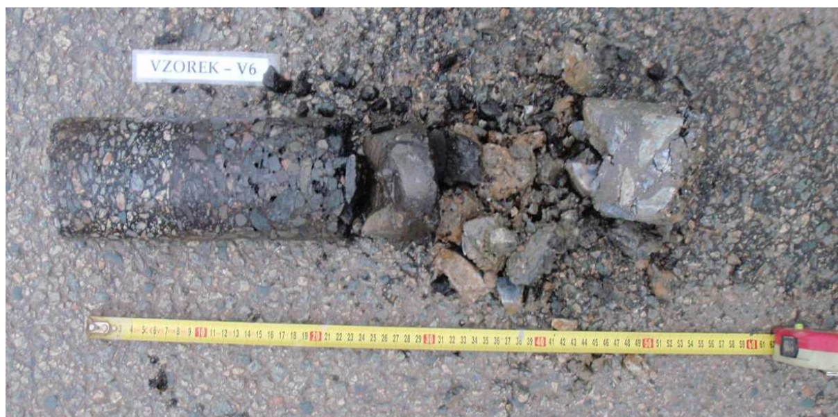
Obr. 11 - Jádro vývrtu Vzorek – V6 (in situ).
