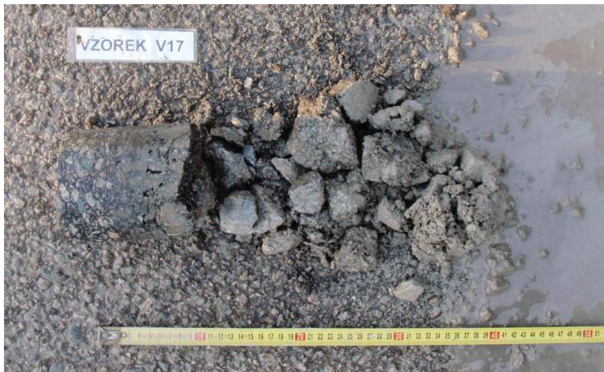
Obr. 33 - Jádro vývrtu Vzorek – V17 (in situ).
