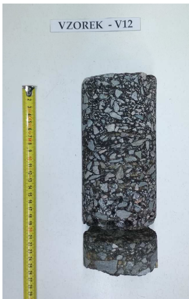
Obr. 24 - Jádru vývrtnu Vzorek – V12 (laboratoř).
