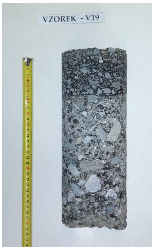
Obr. 38 - Jádru vývrtu Vzorek – V19 (laboratoř).
