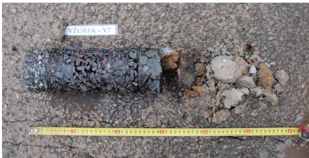
Obr. 13 - Jádro vývrtu Vzorek – V7 (in situ).
