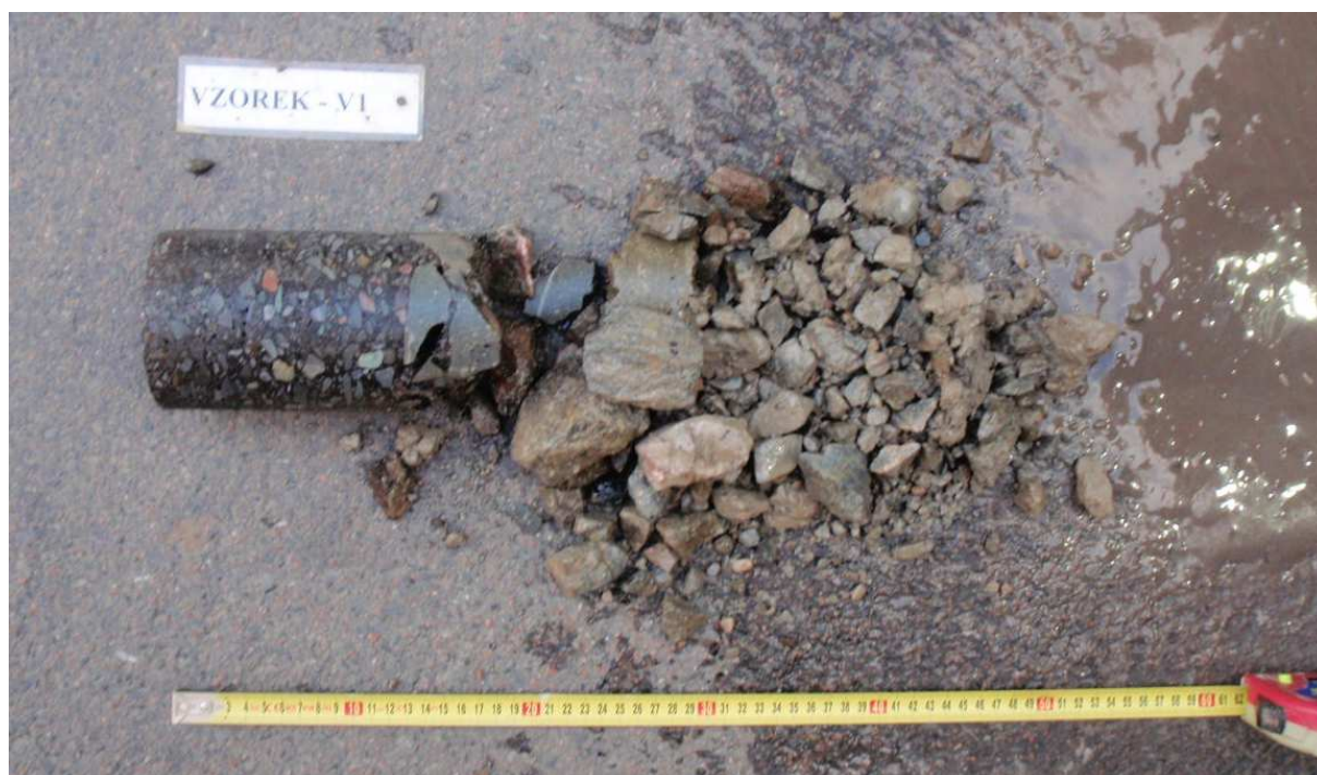
Obr. 1 - Jádro výtvetu Vzorek – V1 (in situ).
