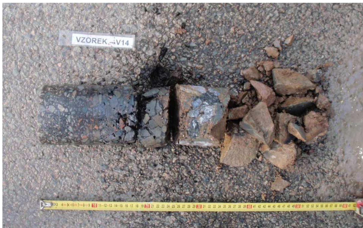
Obr. 27 - Jádro výtvetu Vzorek – V14 (in situ).
