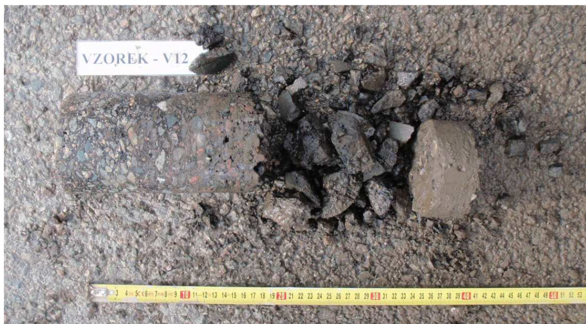
Obr. 23 - Jádro vývrtu Vzorek – V12 (in situ).
