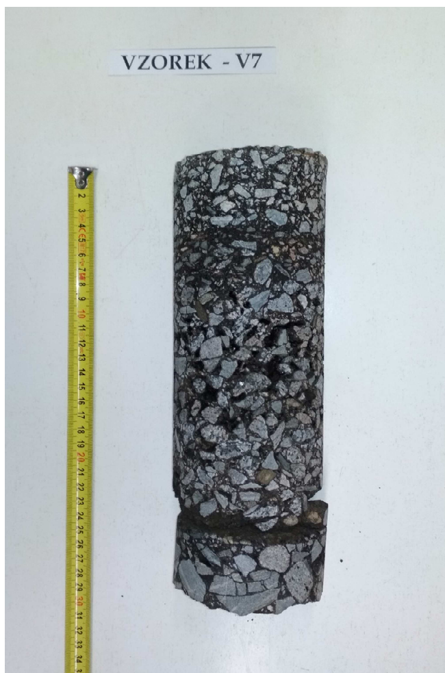
Obr. 14 - Jádro vývrtu Vzorek – V7 (laboratoř).
