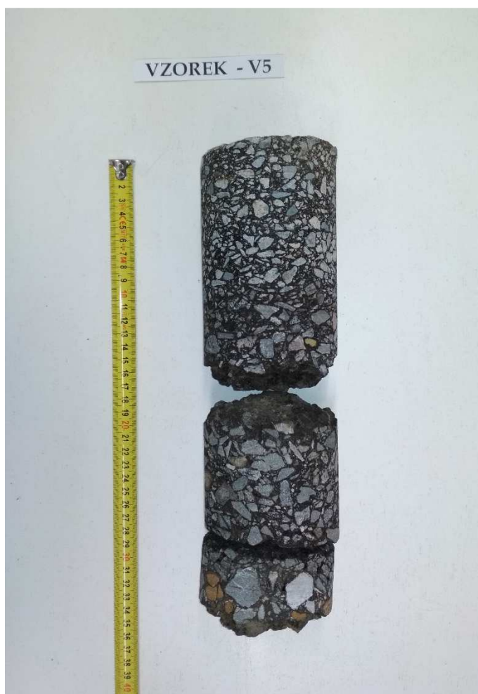
Obr. 10 - Jádro vývrtu Vzorek – V5 (laboratoř).
