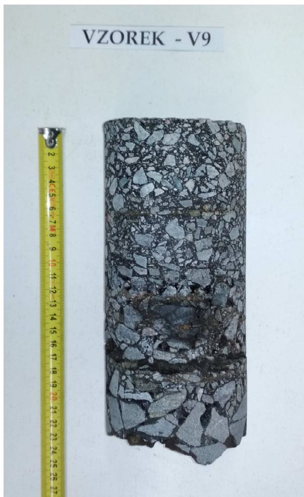
Obr. 18 - Jádro vývrtu Vzorek – V9 (laboratoř).
