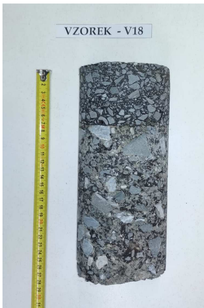
Obr. 36 - Jádro vývrtu Vzorek – V18 (laboratoř).
