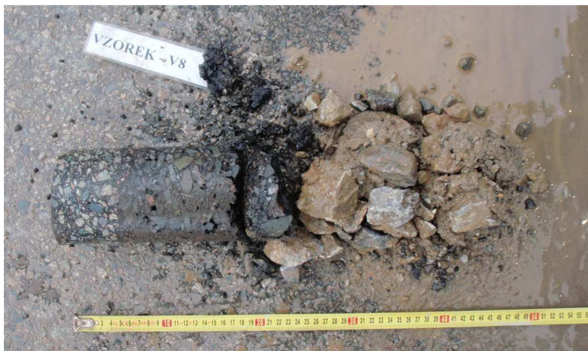
Obr. 15 - Jádro vývrtu Vzorek – V8 (in situ).
