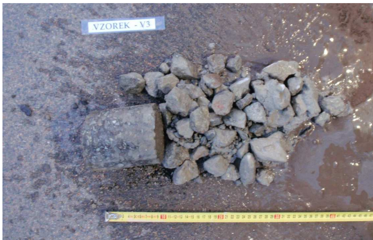
Obr. 5 - Jádro vývrtu Vzorek – V3 (in situ).
