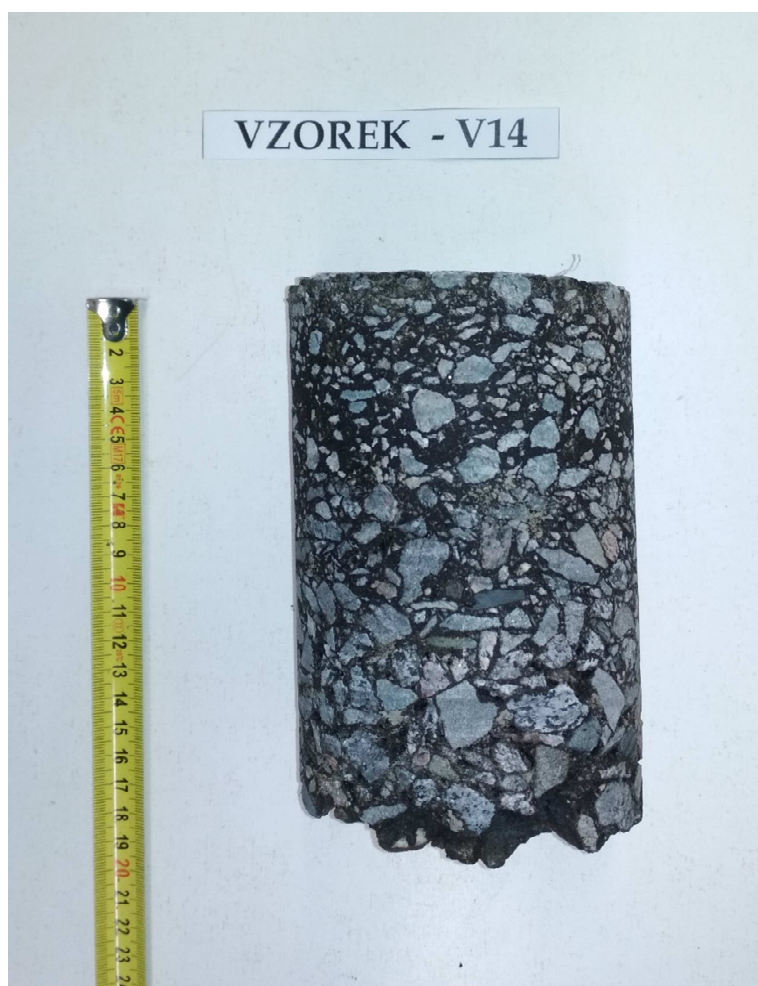
Obr. 28 - Jádru vývrtu Vzorek – V14 (laboratoř).
