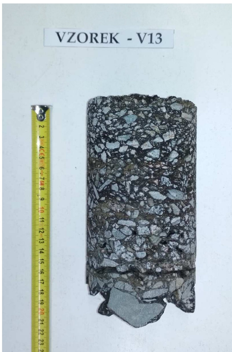
Obr. 26 - Jádru vývrtu Vzorek – V13 (laboratoř).
