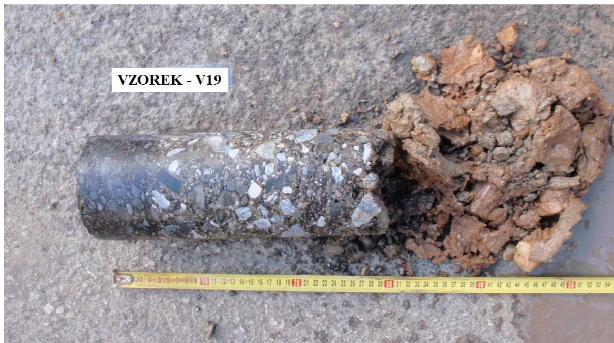
Obr. 37 - Jádro vývrtu Vzorek – V19 (in situ).
