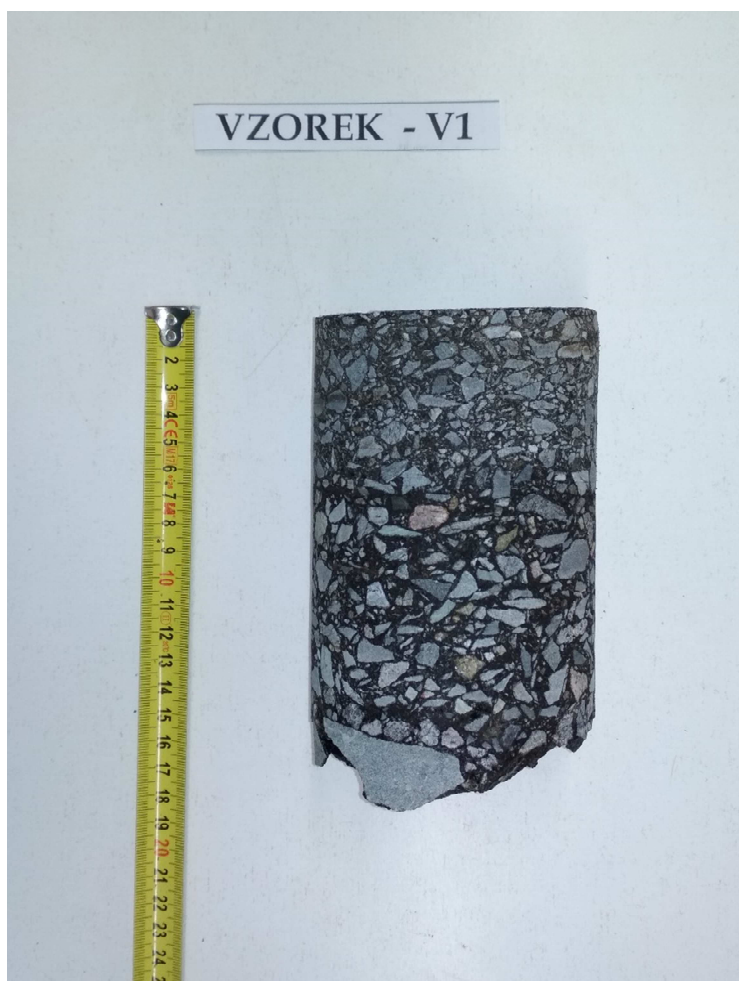
Obr. 2 - Jádro vývrtu Vzorek – V1 (laboratoř).
