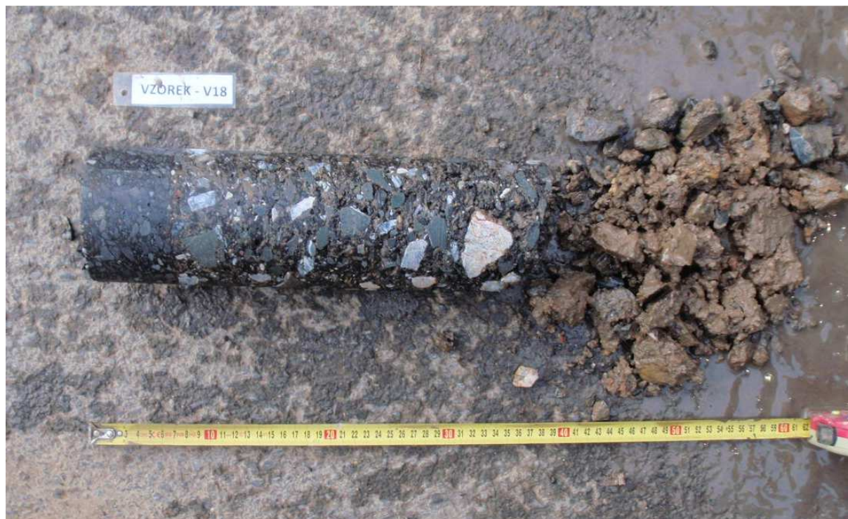
Obr. 35 - Jádro vývrtu Vzorek – V18 (in situ).
