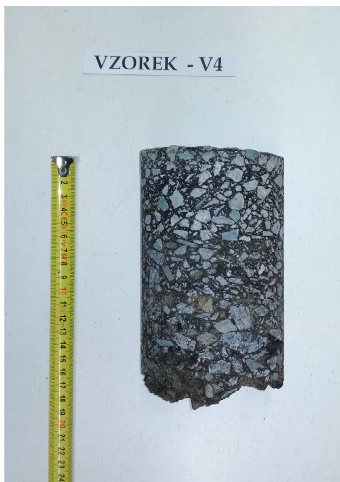
Obr. 8 - Jádru vývrtu Vzorek – V4 (laboratoř).
